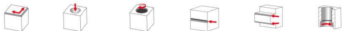
面取り加工 センター加工 皿面取り加工 側面取り加工 裏面取り加工 側面V溝加工
